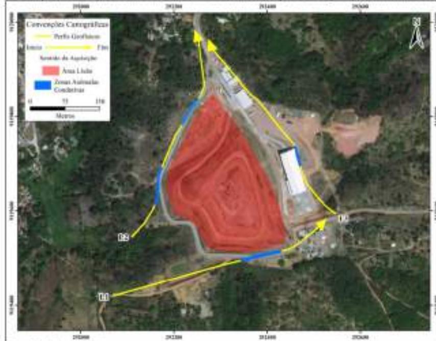
Figura 16 - Mapa com a indicação das zonas anômalas condutivas evidenciadas nos perfis de tomografia elétrica referentes ao Grupo 01.
